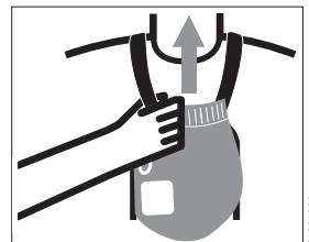
**Le sac respiratoire se remplit en 1 à 2 minutes. Si la cartouche de démarrage ne peut pas être activée, remplir l'autosauveteur à oxygène au moyen de 4 à 5 fortes expirations dans le demi-masque afin de déclencher la réaction de la substance chimique (voir "Production d'oxygène" à la page 20). A cet effet, saisir la cagoule par la collerette et l'élargir – expirer directement dans le demi-masque.**
