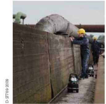
Kablosuz çit/güvenlik hattı Bir kablosuz güvenlik hattı oluşturmak için 25 adete kadar birbiriyle otomatik olarak bağlantılı Dräger X-zone 5000.
