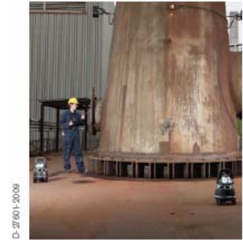
Kablosuz çit/güvenlik hattı Bir kablosuz güvenlik hattı oluşturmak için 25 adete kadar birbiriyle otomatik olarak bağlantılı Dräger X-zone 5000.
